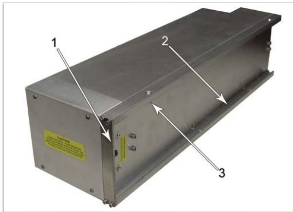
4. Nehmen Sie die Laserröhre an beiden Seiten und neigen Sie sie in einem 30°-Winkel nach unten. Setzen Sie die Kassette auf die Kassettenhalterungen, indem Sie die obere V-förmige Rille auf die Halterungen aufsetzen. Schieben Sie die Kassette nach rechts, bis die **ÄUSSERE KANTE** der Positionierungsplatte die **INNENSEITE** des großen Stegs des Positionierungsprofils berührt.
