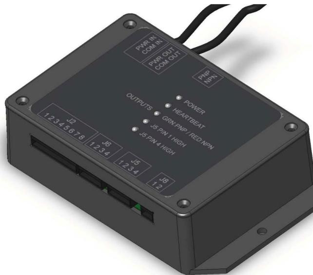
3. Verbinden Sie dann das andere Ende des Patchkabels mit der PWR/COM IN RJ9-Steckverbindung oben an der Automatisierungsschnittstelle.
