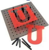
Der mit Stiften konfigurierbare Tisch wurde entwickelt, um Brandspuren und andere Defekte zu beseitigen, die beim Schneiden von Acryl, Holz oder anderen empfindlichen Materialien mit herkömmlichen Laserschneidetischen auftreten können. Durch die Verwendung speziell beschichteter Aluminiumstifte, die das zu bearbeitende Material anheben, reduziert der Universal Pin Table die Menge an Laserenergie, die von der Tischoberfläche zurück in das Material reflektiert wird, erheblich.
