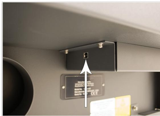
**ACHTUNG:** Das Lasersystem wird mit einem hochwertigen, USB2.0-tauglichen Kabel (2 m lang) ausgeliefert. Es wird empfohlen, nur dieses Kabel zu verwenden. Verwenden Sie keine Adapter, Verlängerungskabel, USB-Kabel länger als 2 m, oder andere Geräte zwischen dem USB-Anschluss des Computers und dem Anschluss des Lasergerätes, da dies zu Problemen beim Datentransfer führen kann
